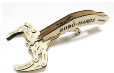
平行リンク型ロボットハンド
